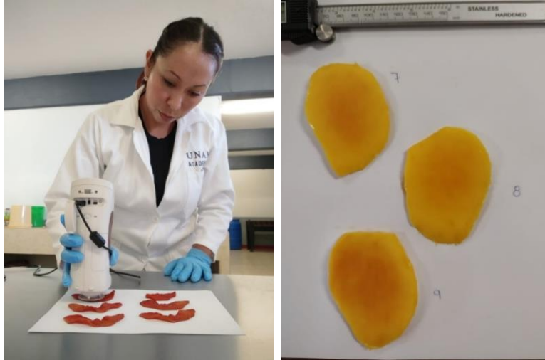
Figura 5.- proceso de medición de color en rebanadas de papaya y mango utilizando un colorímetro, las mediciones se realizaron cada media hora y con ellas se obtuvieron los datos de cambio de color.
