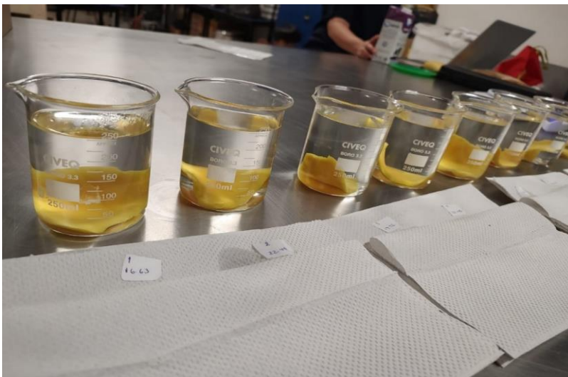
Figura 6.- proceso de Rehidratación de las rebanadas de fruta deshidratada, utilizando vasos de precipitado, agua a una temperatura constante de 60°C, papel absorbente y una bascula digital, donde cada 5 minutos se retiraban las rebanadas del agua para pesarlas y obtener el índice de Rehidratación
