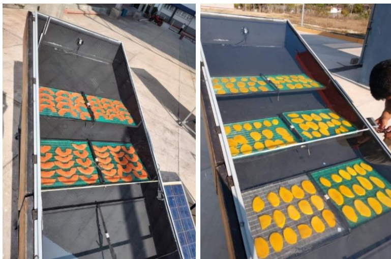
Figura 4.- proceso de deshidratación solar de los frutos, cada media hora se retiraban las muestras para pesarlas y llevar el control de pérdida de peso, de donde se obtuvieron las curvas de secado.
